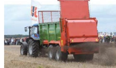
Разбрасыватель удобрений HERKULES N262 грузоподъемностью 12 тонн в действии. Участникам показа рекомендуется отойти на несколько шагов назад – ширина разброса составляет 25 метров (конечно же, с возможностью регулирования)
