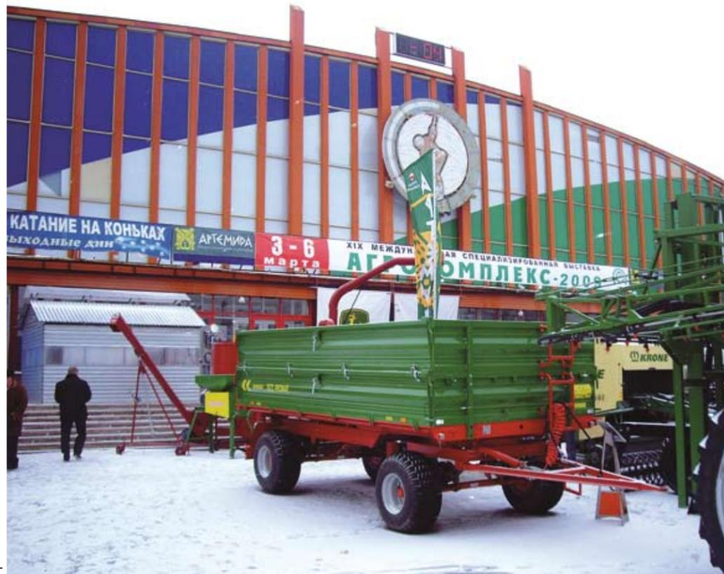
Двухосный прицеп PRONAR T672, грузоподъемность 8 тонн
