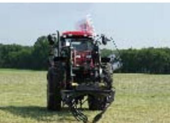
В ходе показа операторы фирмы Pronar демонстрируют работу фронтального погрузчика с захватом для рулонов
