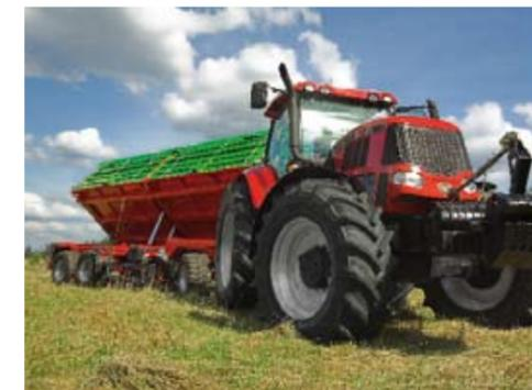
Одновременное испытание прицепа на тридцем-шасси T780 и трактора модели PRONAR 8140 с трехточечной задней навеской: боковой наклон на 45 градусов, а через минуту опрокидывание назад
