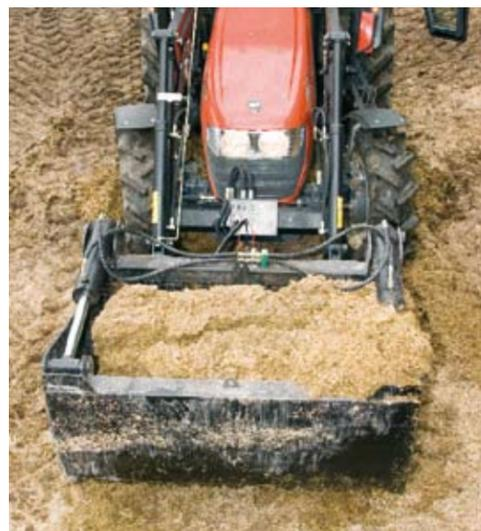
При помощи резчика силоса, работающего вместе с фронтальным погрузчиком, можно также перевозить корм к месту кормежки
