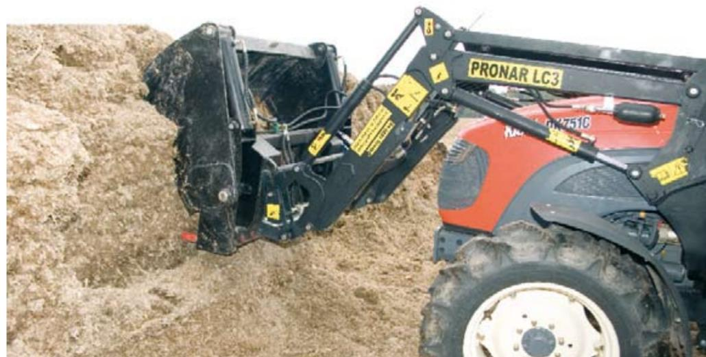
Резчик силоса, установленный на фронтальном погрузчике, позволяет вырезать блоки по всей высоте призмы силоса
