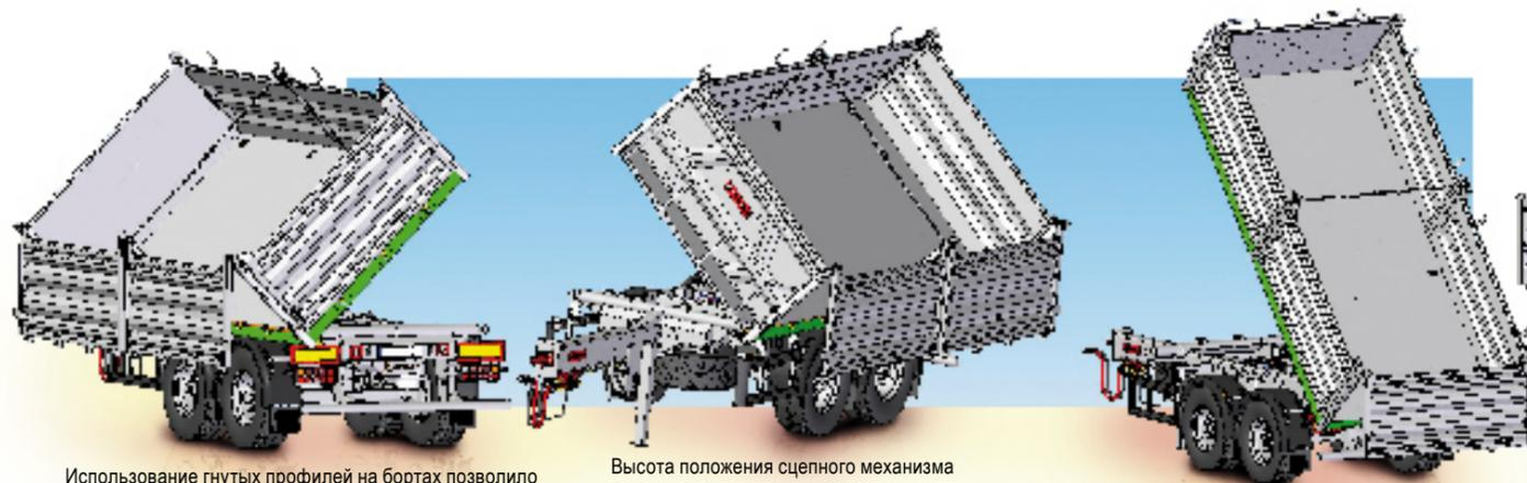
Использование гнутых профилей на бортах позволило укрепить их без приварки дополнительных укрепляющих элементов
