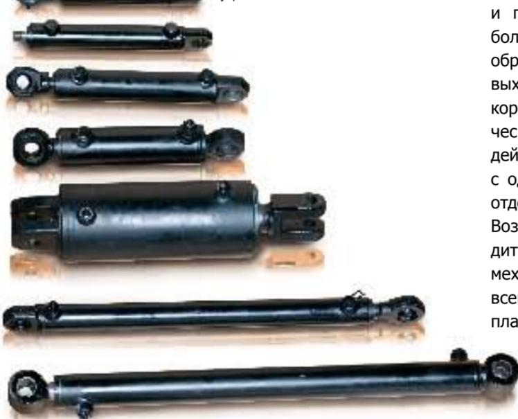
Плунжерные гидродвигатели – это гидродвигатели одностороннего действия, в которых рабочая жидкость (масло под давлением) подается в цилиндр только по одному проводу, вызывая выдвижение плунжера (выходного звена). Возврат плунжера происходит при помощи пружины или под действием какой-либо другой внешней силы.
