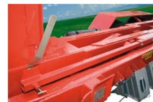
Рычаг управления рамами прицепа в промежуток между закреплением/отсоединением и опрокидыванием контейнера
