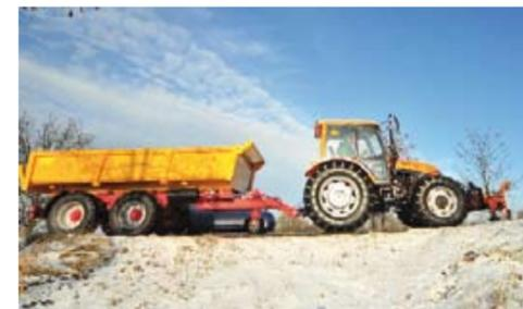
Оборудование испытывается при различных погодных условиях. На фотографии: Трактор Zefir мощностью 85 л. с. (версия для коммунального хозяйства) со строительным прицепом T679/2 во время зимних испытаний
