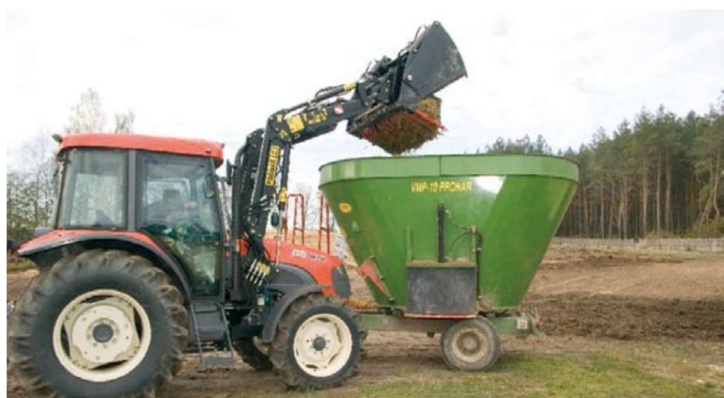
Благодаря возможности разгрузки корма при помощи резчика силоса, установленного на фронтальном погрузчике на достаточной высоте, можно без труда загружать кормораздатчик VMP-10
