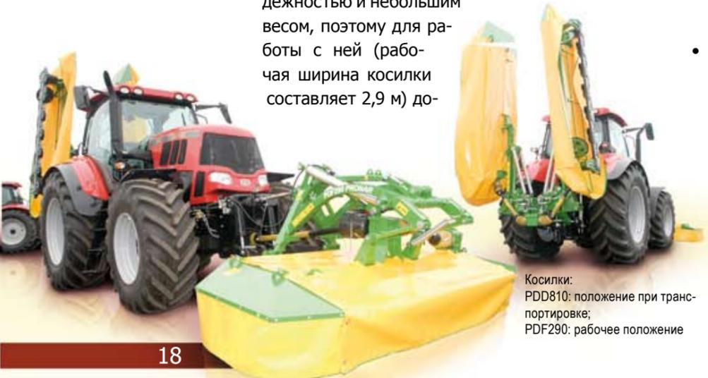
Косилки: PDD810: положение при транспортировке; PDF290: рабочее положение
