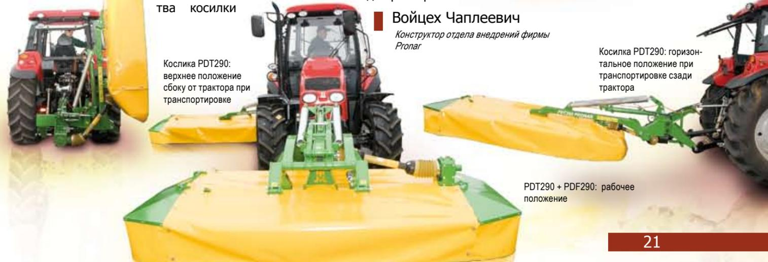
Косилка PDT290: верхнее положение сбоку от трактора при транспортировке
