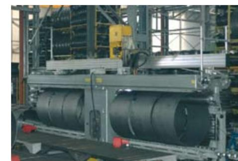
Установка для плазменной сварки колец
